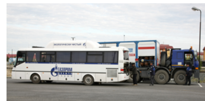
Передвижной автогазозаправщик заправляет компримированным природным газом автобус
