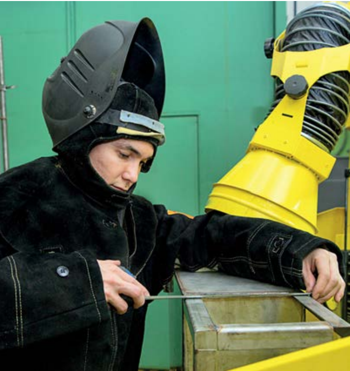
Иван Васильев, электрогазосварщик УАВР, готовится к сварке нержавеющей стали в среде аргона
