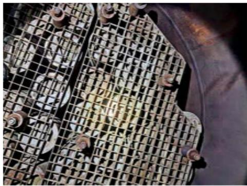
Фильтры в газосепараторах очищают поступающий из скважин сырой газ от твёрдых частиц и жидкости
