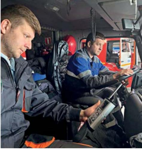
Инструментальные замеры шума и вибрации на рабочем месте водителя пожарного автомобиля
