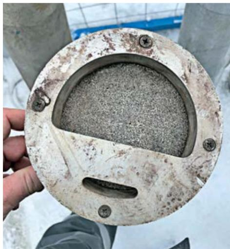
Фильтры из пористого алюминия можно очищать при помощи паровой установки
