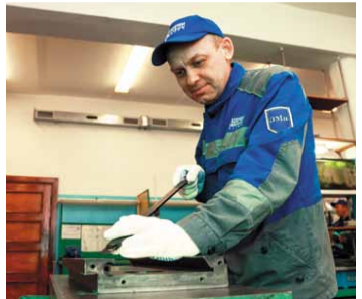
Дмитрий Киселёв работает с шабером – специальным режущим инструментом
