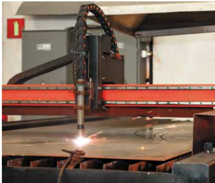
Механизм ведёт резак по заданным координатам чертежей
