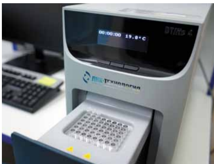
Детектирующий амплификатор исследует образцы ДНК
