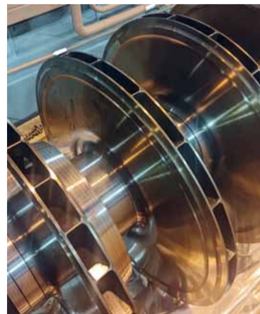
Ротор сменной проточной части
