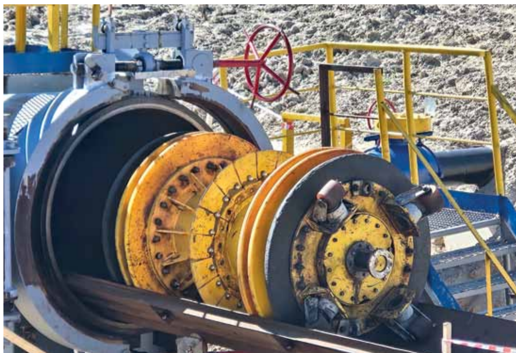
Внутритрубная диагностика позволяет определить техническое состояние газопровода
