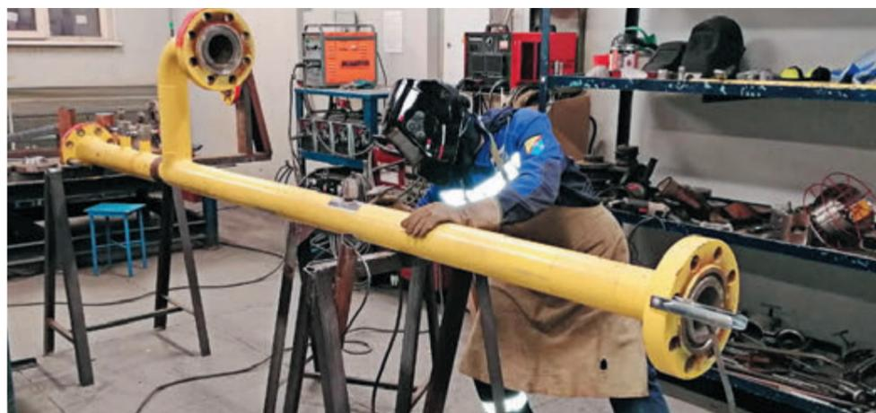
Электросварщик ручной сварки Александр Насибуллин врезает узлы контроля скорости коррозии в тройник трубопровода обвязки газовой скважины
