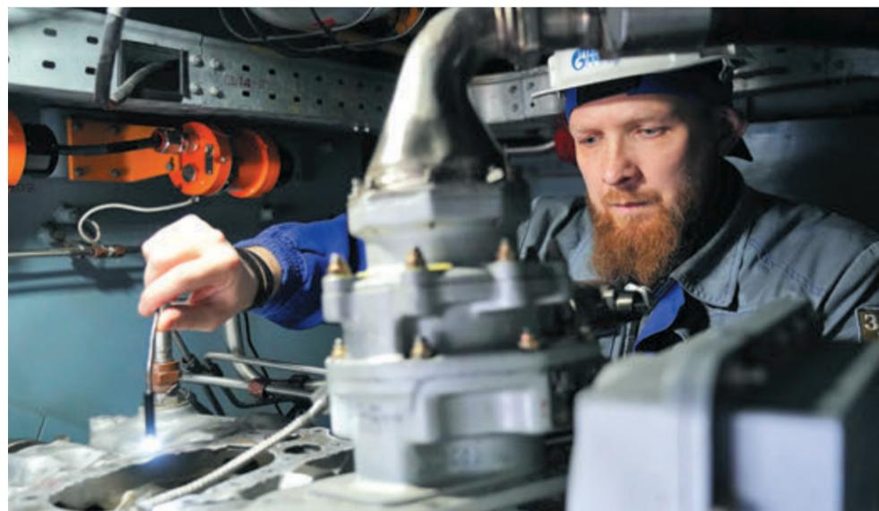
Инженер УЯЭГ Евгений Шикалов производит эндоскопический осмотр газотурбинного двигателя
