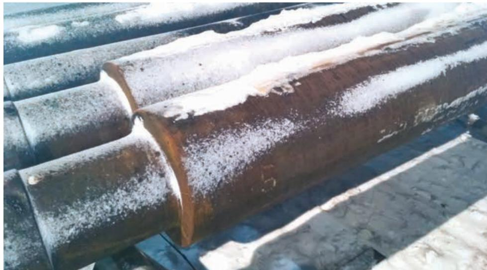
Теплоизолированное направление с пенополиуретановой теплоизоляцией – термокейс
