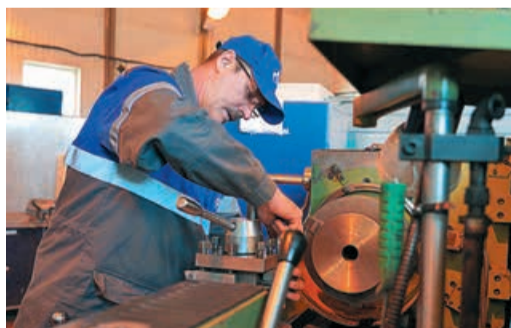
Токарь Сергей Кузнецов занят изготовлением шкива для электродвигателя
