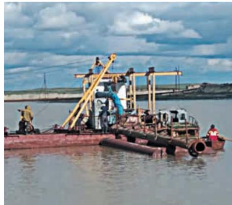
Метод гидронамыва при добыче песка на Ямале
