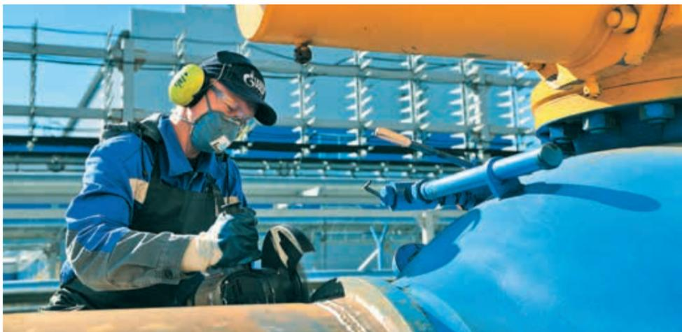
Антон Егоров, слесарь-ремонтник, занят ремонтом шарового крана на базе сервисного обслуживания БНГКМ
