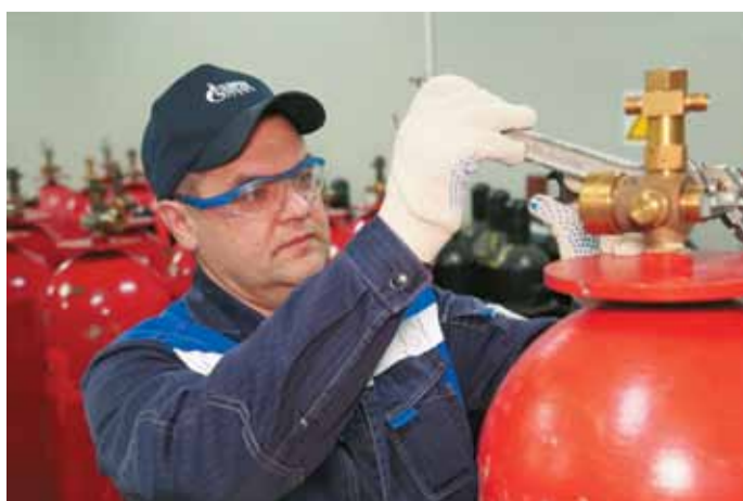
Сергей Елисеев, слесарь-ремонтник, проводит гидро-, пневмоиспытания и заправку углекислотой модулей пожаротушения
