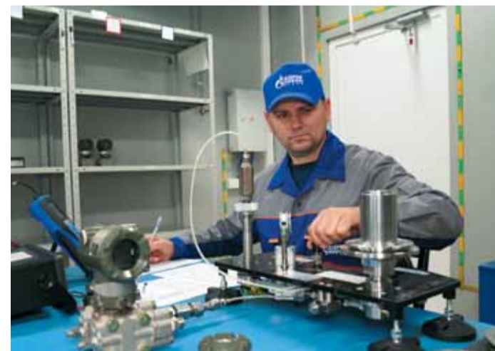
Алик Муллагаев, слесарь КИПиА, готовит к поверке преобразователь давления
