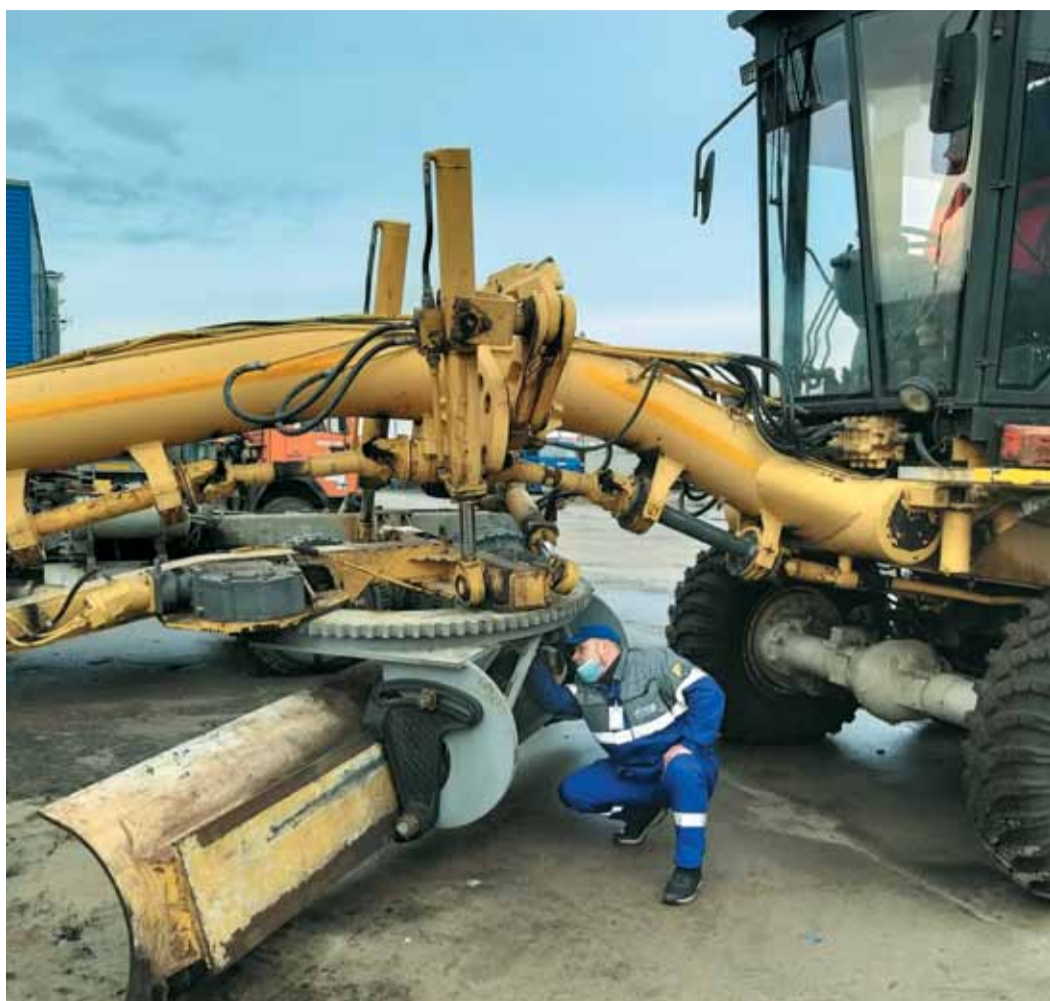
Мастер РМУ Михаил Михайлов проверяет регулировку круга и бугелей среднего отвала автогрейдера
