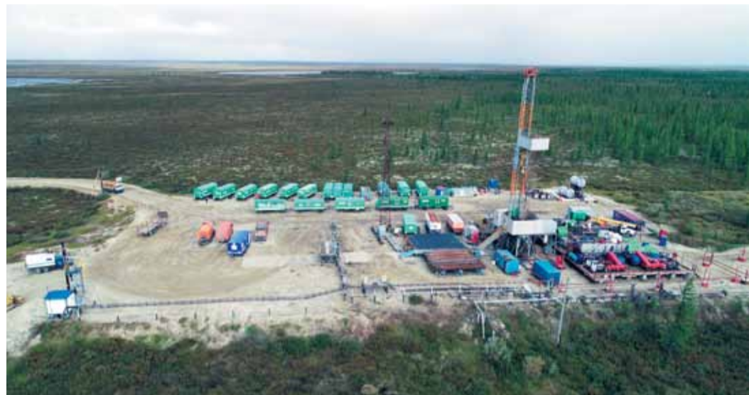
Забурка бокового ствола на скважине №292 Южно-Юбилейной площади
