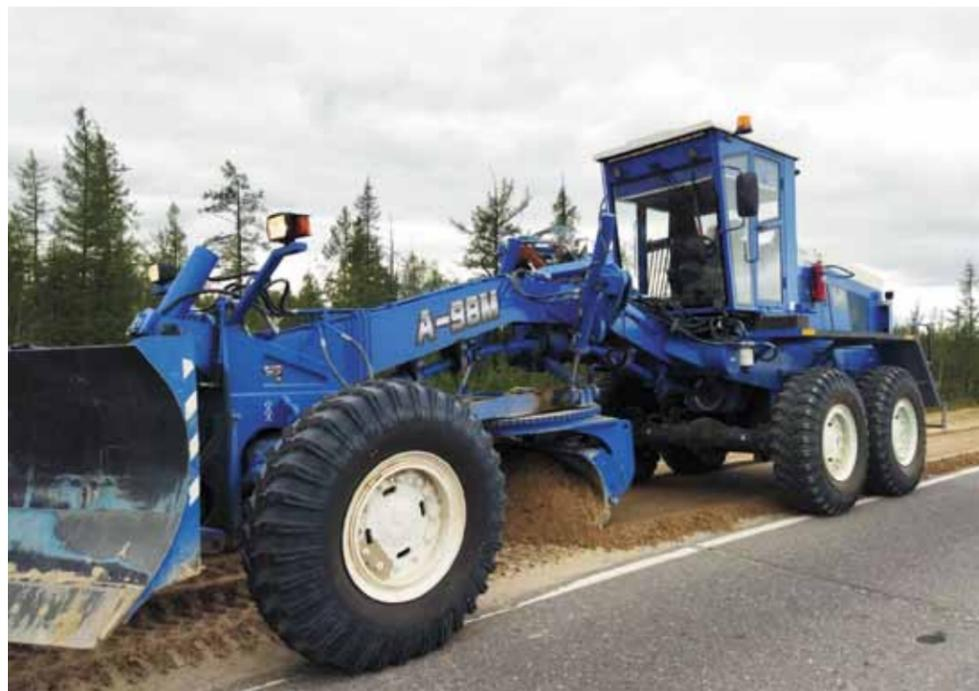
Автогрейдеры наши дорожники используют для очистки дорожного полотна от наледи и снега, а также при планировке обочин, откосов и проезжей части грунтовых дорог
